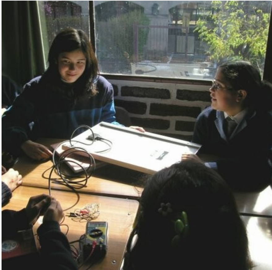
4. Se observa que incluso iluminado desde atrás, el panel es capaz de producir energía
