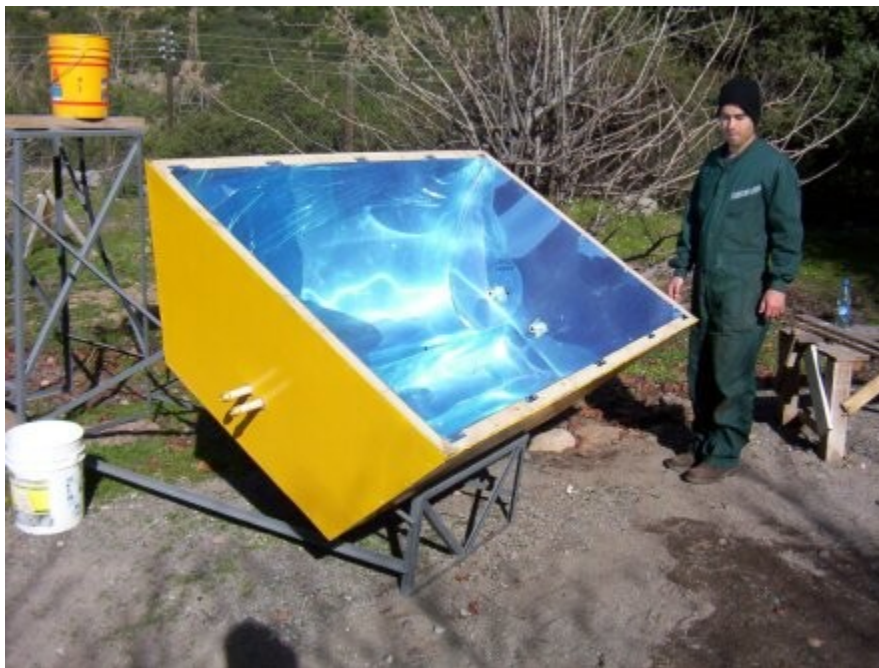
6. Nuevo sistema de calentador solar durante su montaje en San José
